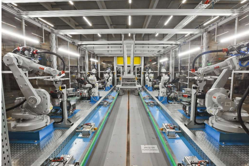
Foto 1: Blick in das Innere der Maschine mit den Robotern, die für die Montage von Schrauben und Clips zuständig sind
