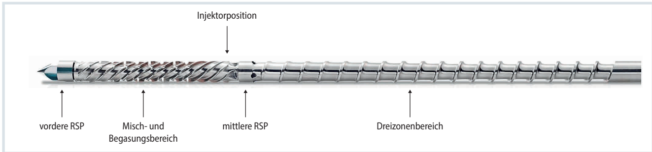
Bild 1. Bisherige Schneckengeometrie für das physikalische Thermoplast-Schaumspritzgießen. © KraussMaffei
