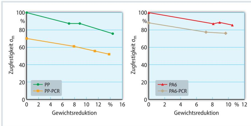
**Bild 1.** Zugfestigkeiten für PP-GF und PA6-GF, jeweils Neuware und Rezyklat im Vergleich. Die Werte aller Untersuchungen sind prozentual (Neuware kompakt = 100 %) dargestellt. Quelle: HS
