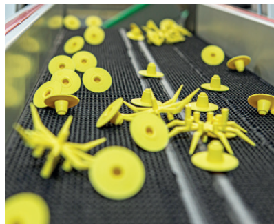
Ohrmarken aus TPU sind besonders flexibel, abriebfest und witterungsbeständig
