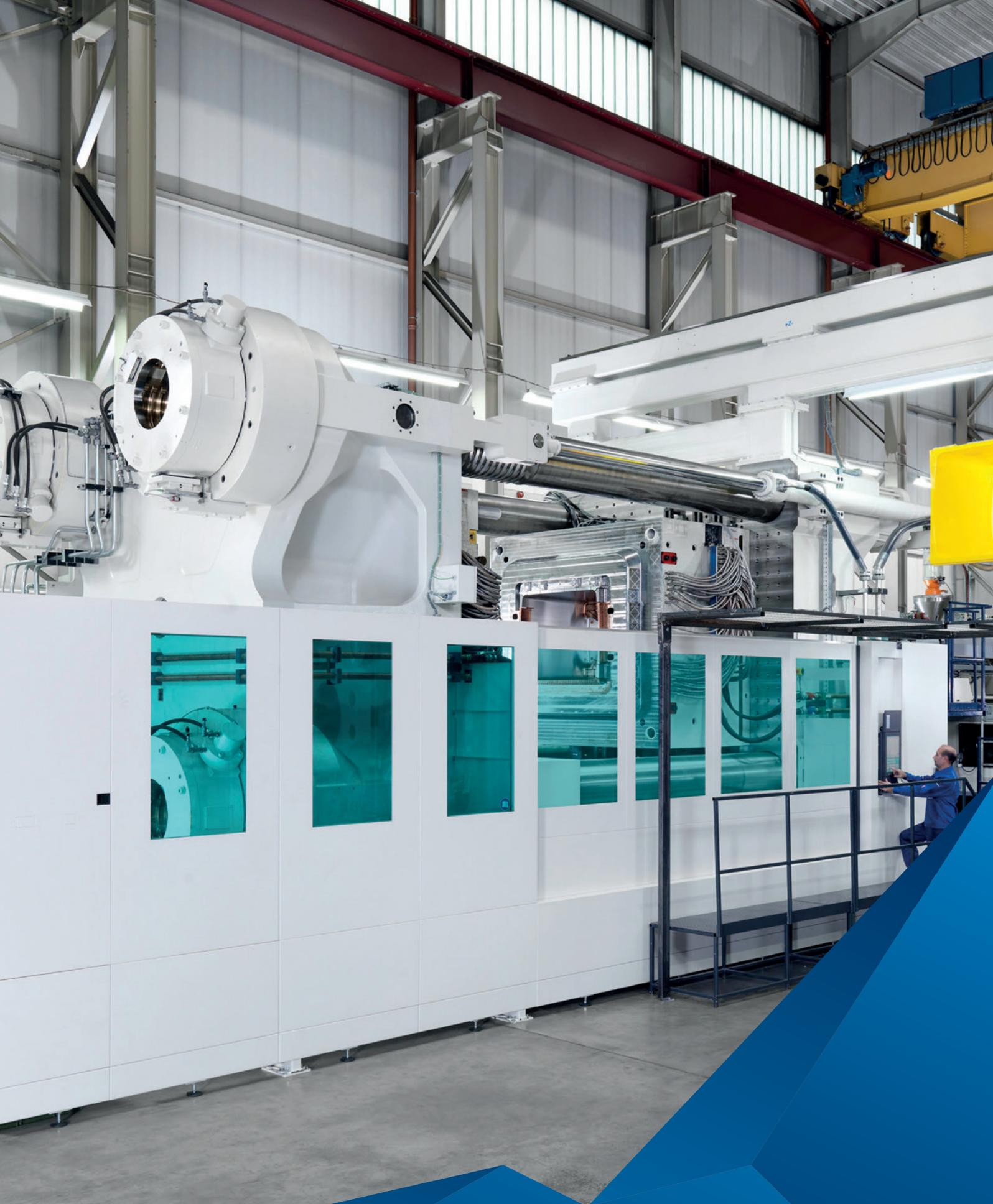
*Rekordmaschine: Mit einer Schließkraft von 5.500 t ist die MXH 5500 die größte KraussMaffei Spritzgießmaschine der Welt.*
