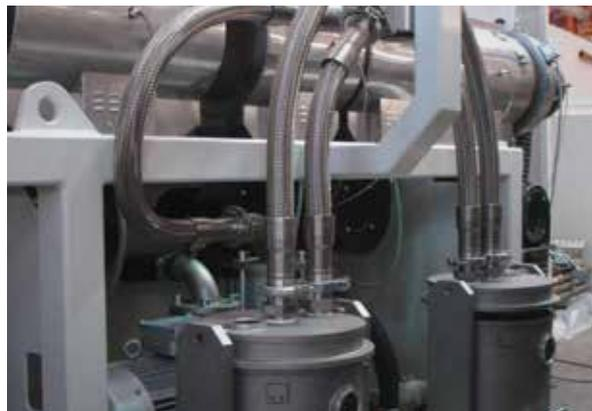
*Vakuumpumpe mit Schneckenaustritt zum Adapter Doppelabscheider*
