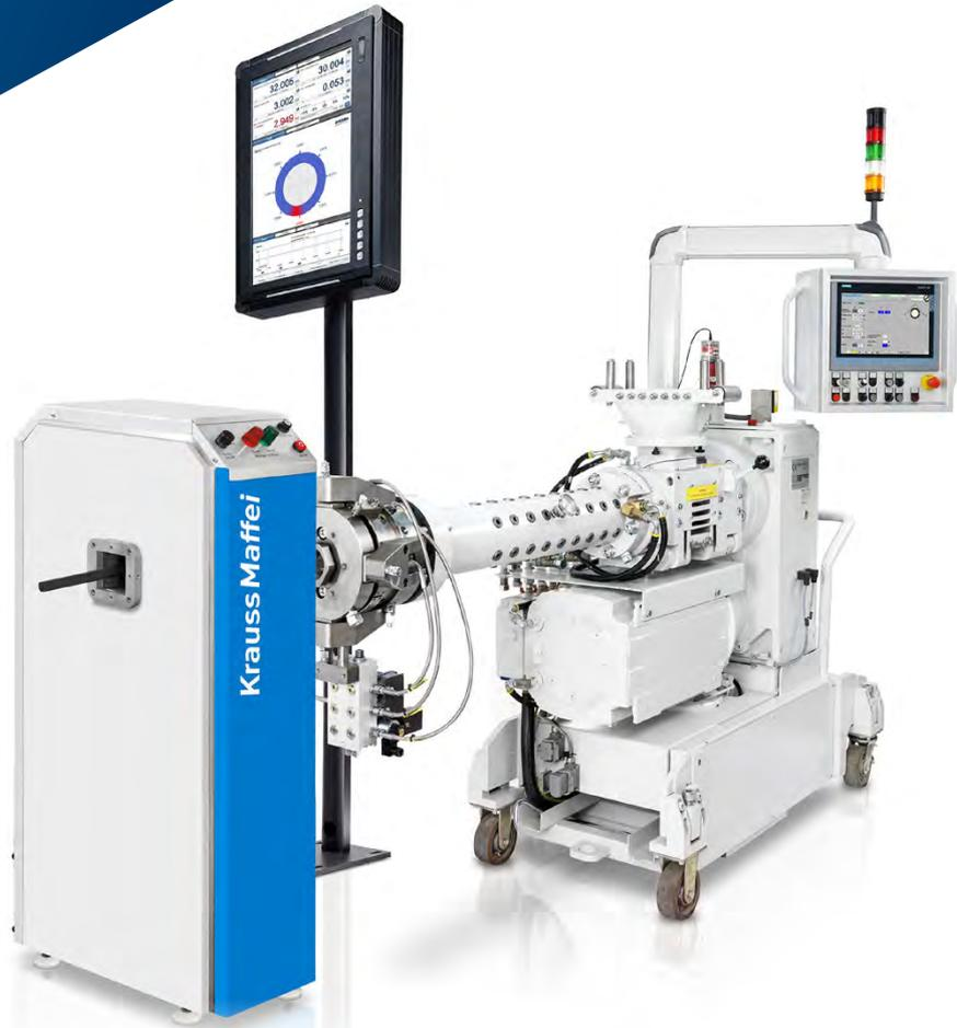
*Gummiextruder mit Geradeaus-Spritzkopf und Röntgenmessgerät*
