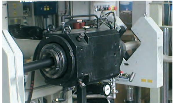
Extrusionskopf zum Ummanteln eines Festigkeitsträgers
