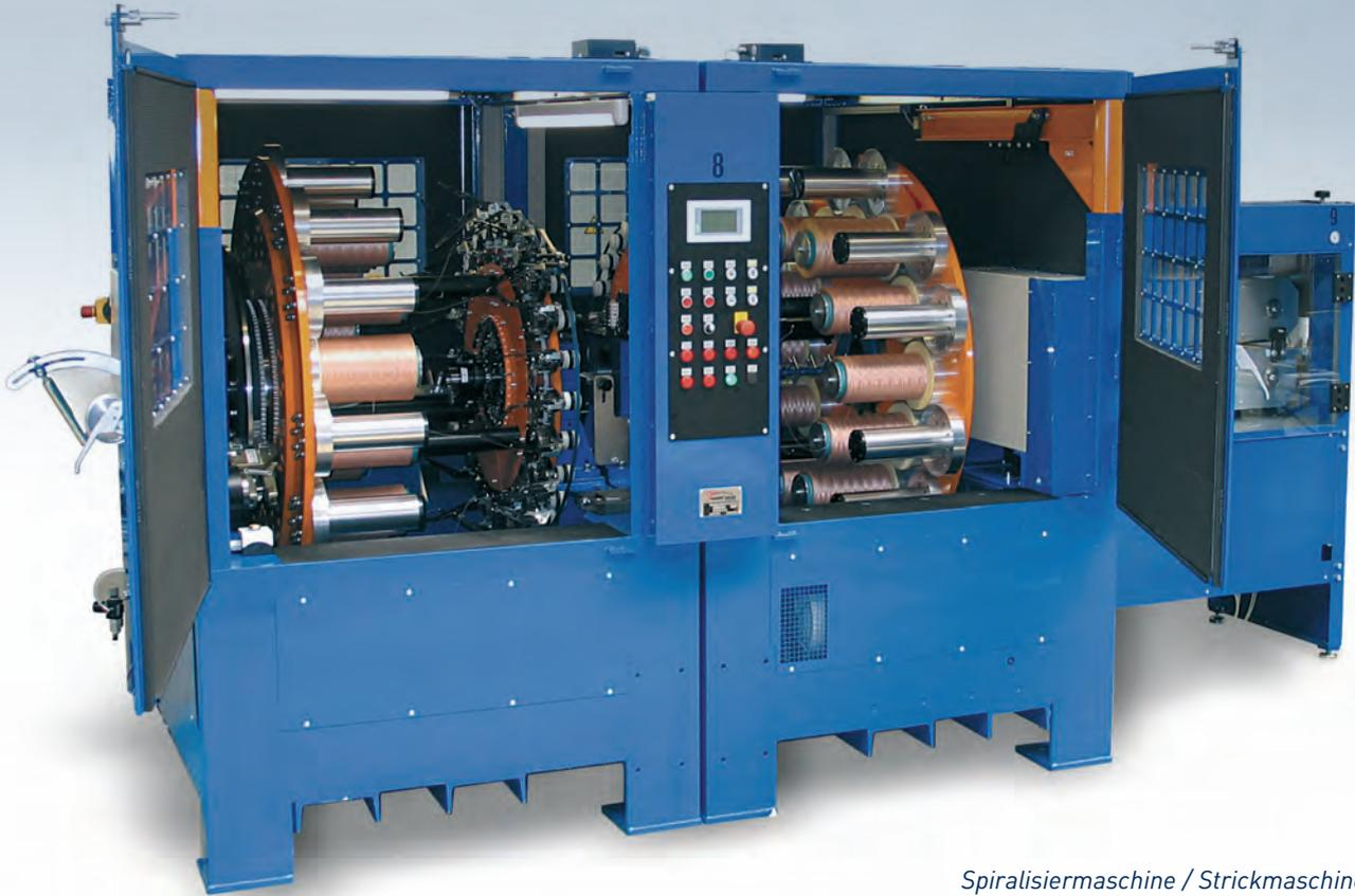
*Spiralisierungsmaschine / Strickmaschine*
