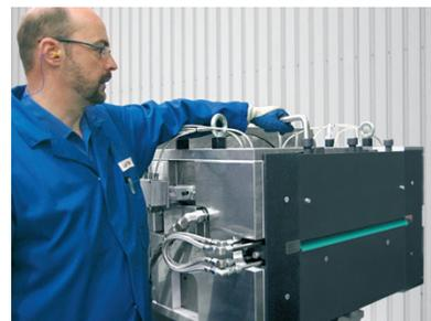
*Speziell abgestimmter Breitspritzkopf für Plattenbreiten bis zu 1.200 mm*
