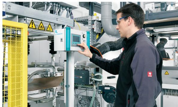
Bedienpanel für die wichtigsten Funktionen direkt an der Anlage
