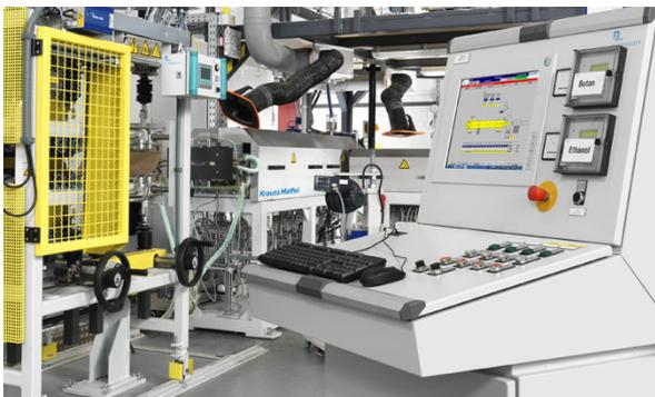
Zentrales Bedienpult überwacht und steuert die komplette Laboranlage
