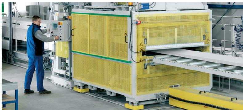
Plattenkalibrator einer Schaumtandex-Anlage
