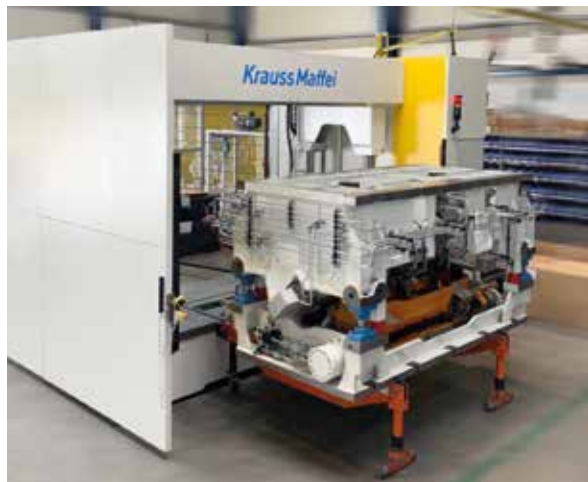
TrimStar Smart: Werkzeugwechsel nach vorne oder zur Rückseite.
