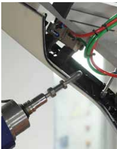
Automatisch entgraten auch bei komplexen Konturen
