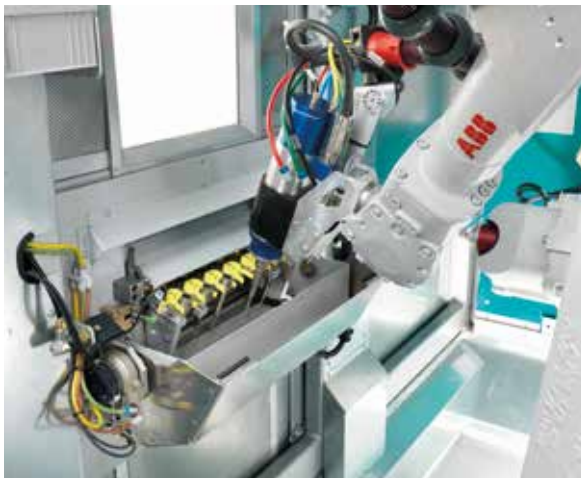
Wechselmagazin für automatischen Fräserwechsel.
