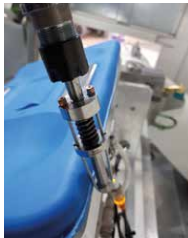
Seilstrangentgratung: PUR-Bauteile automatisch oberflächenschonend entgraten
