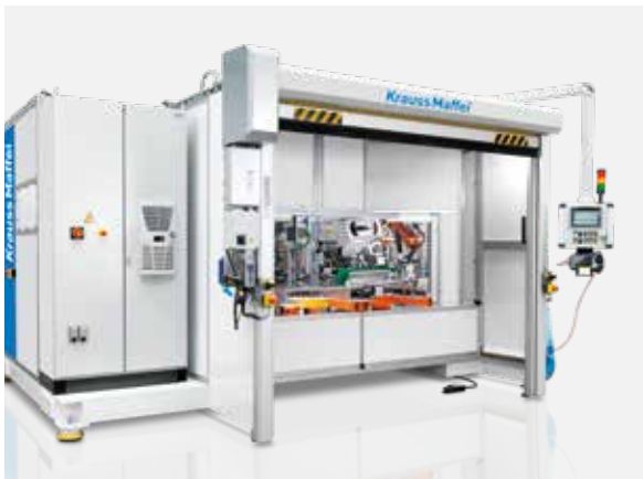
ScoringStar RA, Scoring und Trennmiteleintrag in einer Anlage.
