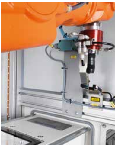
RobDeflash : Entgrat Bauteil-Aufnahme
