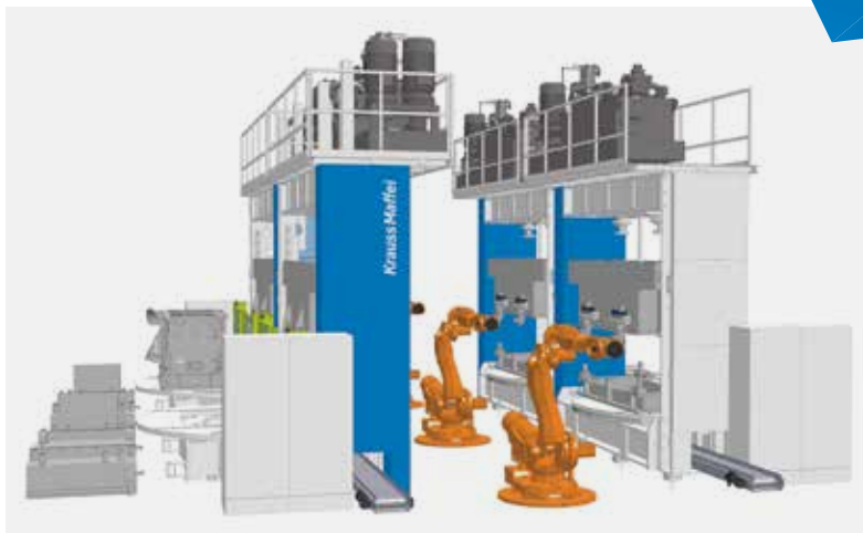
PunchStar RA mit Rundtischanlage für vollautomatischen Werkzeugwechsel.
