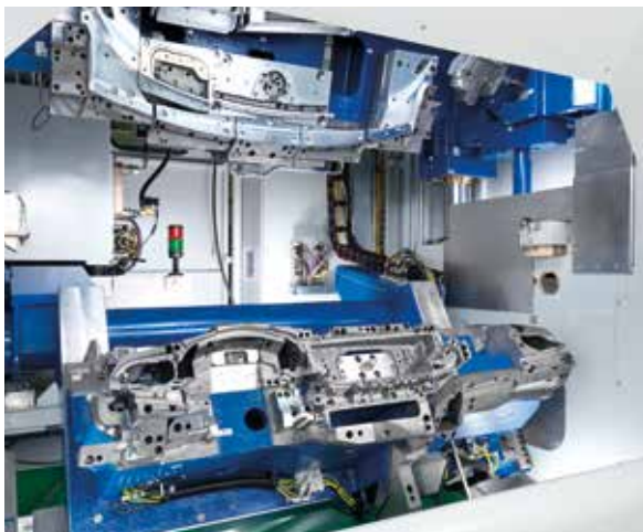
Ergonomisch: Stanzwerkzeug für Instrumententafel in Beladeposition.
