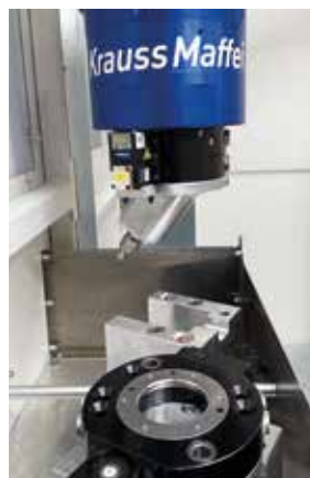
Automatische Ankoppelung des Ultraschallwerkzeuges.
