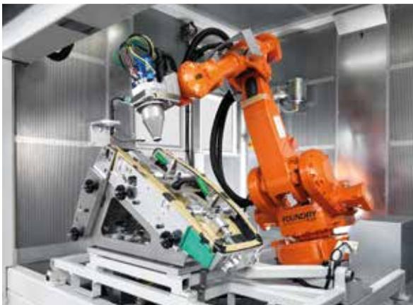
*Roboterfräsanlage für Hubschraubersitze*
