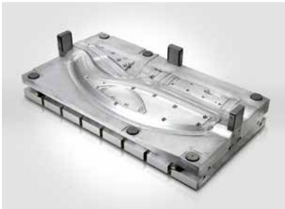
Beheiztes Presswerkzeug für Faserverbundbauteile
