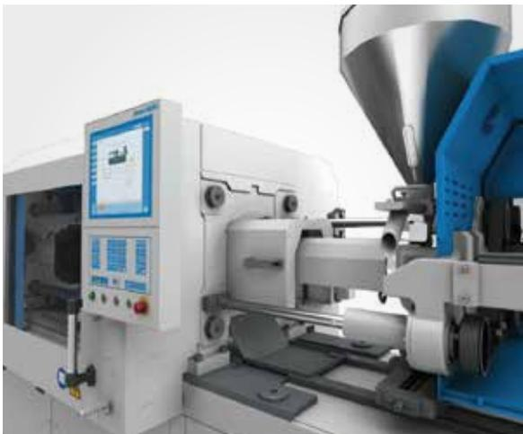
*Bewegung der Einspritzeinheit über zwei parallele elektrisch angetriebene Kugelgewindeschnecken*
