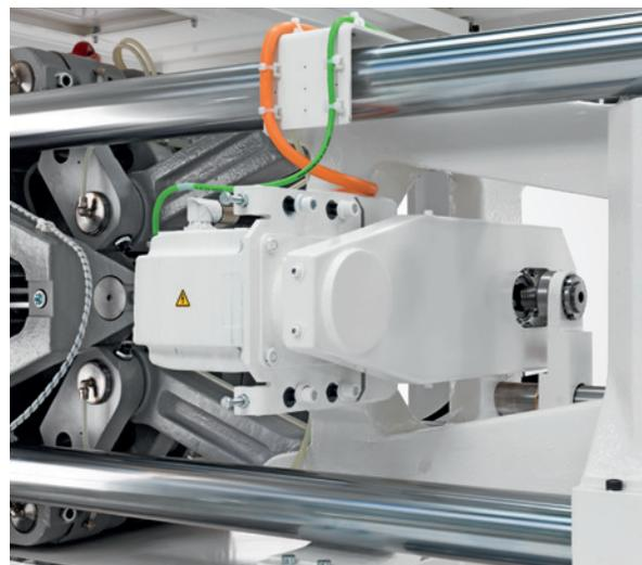
**Mehr Speed:** Die erhöhte Auswerfergeschwindigkeit gleicht bei fallenden Teilen die dynamische Bewegung der Schließe aus.
