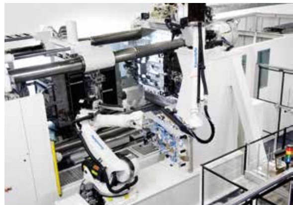
MX-Baureihe als Dreikomponenten-SpinForm-Technologie (Wendeplatte) ausgeführt.
