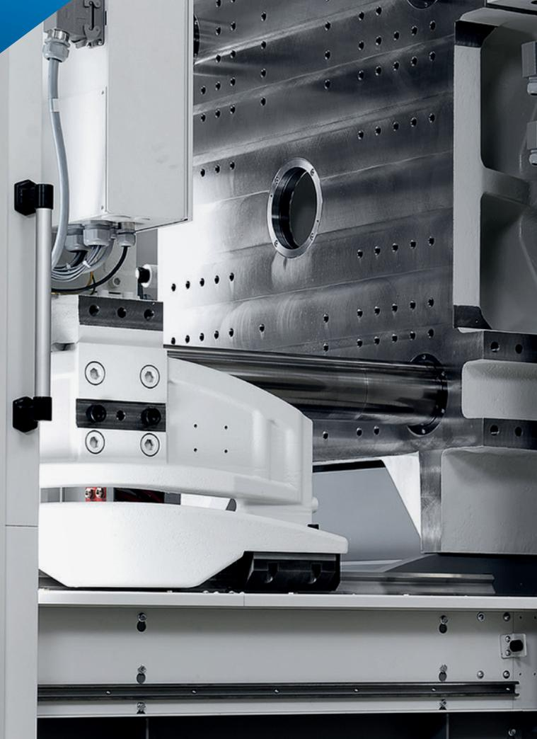
**Die hydromechanische Zweiplatten-Schließereinheit sorgt zusammen mit GearX und GuideX für höchste Formteilqualität und Produktivität.**
