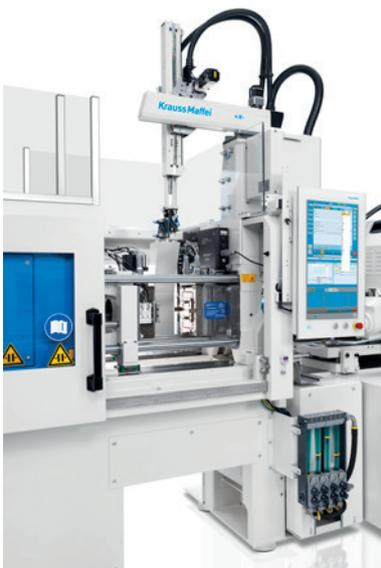
*Der Einstieg in die Automation mit dem servoelektrischen Picker SPX 10 für eine schnelle und präzise Bauteilentnahme.*
