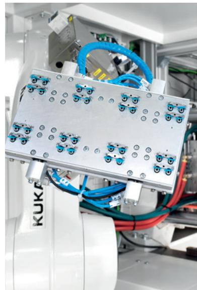
*Hauseigene Greifertechnik für hochpräzises Abziehen von 32 Membranen mit einer Wandstärke von nur 0,2 Millimeter.*
